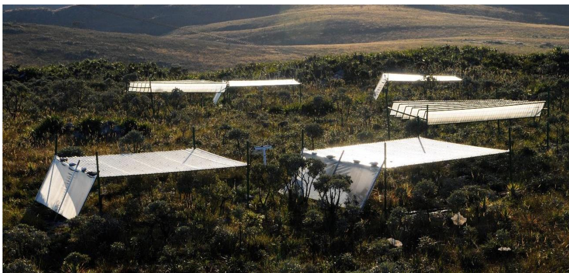
Fig. 2. Experimento de exclusão de água da chuva em vegetação de campo rupestre no Parque Nacional da Serra da Canastra. Parcelas com o telhado coberto representam as parcelas de exclusão de água da chuva e aquelas com o telhado aberto representam as parcelas controle (Fotografia: Rafael Oliveira).
